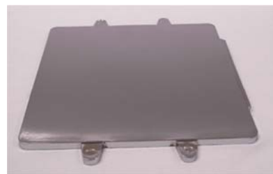
大氣電漿預處理之塑件腐蝕結果
