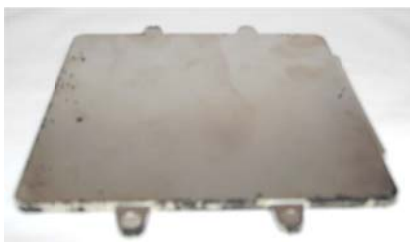
傳統預處理鍍鍍腐蝕後結果
